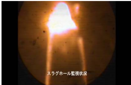
煤渣从煤渣孔落下
